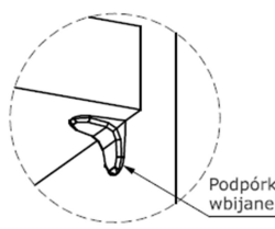
rys. 2 i 3 – wygląd podpórki półki wbijanej
