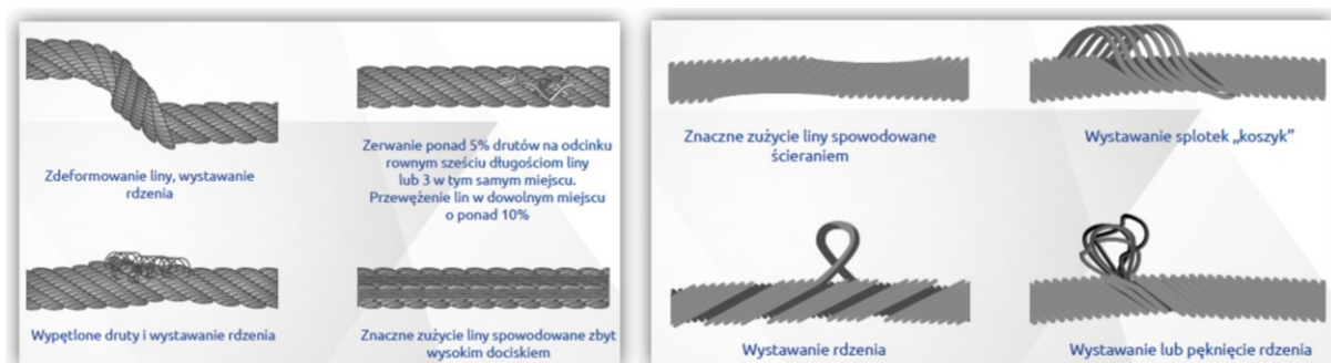
Rysunek 21 Zawiesia linowe – znamiona uszkodzeń
