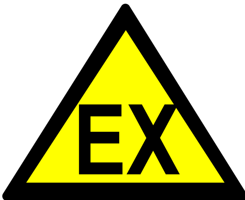
Rysunek A. 2. Znak ostrzegawczy informujący o możliwości wystąpienia atmosfer wybuchowych w ilościach zagrażających bezpieczeństwu i zdrowiu.
