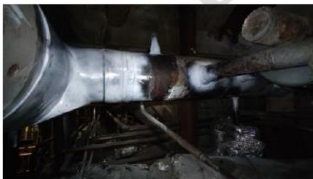
Fot. 7.2.5. Wskazania na króćcu obejścia za GZP.
