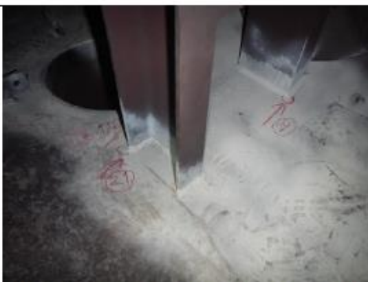
Rys. 8 Wskazania na złączu spawanym wspornika separacji,
