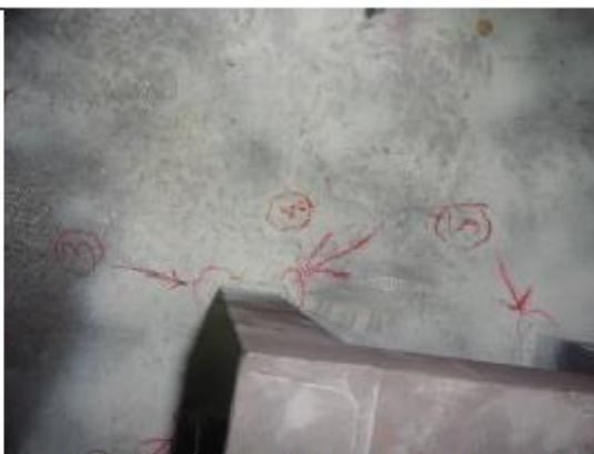
Rys. 4 Wskazania na złączu spawanym wspornika separacji,
