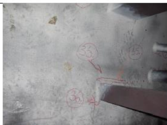
Rys. 17 Wskazania na złączy spawanym wspornika separacji.
