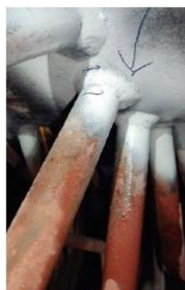
Rys. 3. Wskazanie nr 2 na króćcu na części lewej komory patrząc od tyłu kotła.
