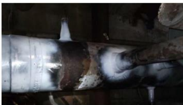
Fot. 7.2.6. Wskazania na króćcu obejścia za GZP.
