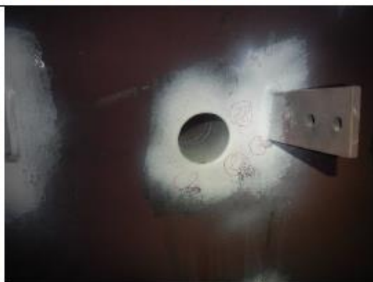
Rys. 12 Wskazania na złączu spawanym wspornika separacji.
