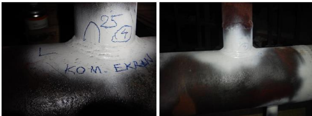
Rysunek 14 Wskazanie na 4. króćcu (licząc od przodu do tyłu kotła).
