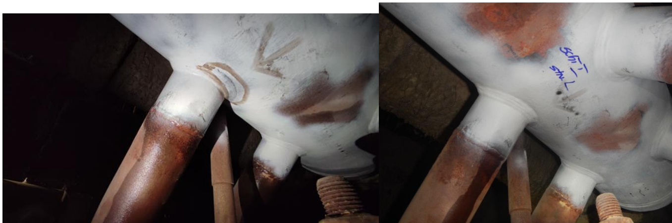
Rysunek 16 Wskazania na pachwinowym złączu spawanym króćca schładzacza I stopnia po stronie lewej kotła.
