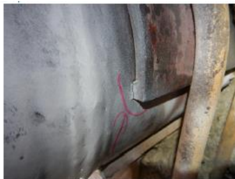
Rys. 6 Wskazanie na spoinach łączących podkładkę pod obejmą z rurociągiem. Schładzacz SP2 przód strona lewa
