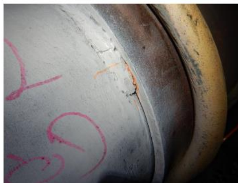
Rys. 4 Wskazanie na spoinach łączących podkładkę pod obejmą z rurociągiem. Schładzacz SP2 przód strona prawa
