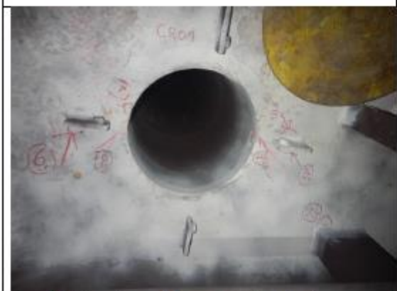
Rys. 5 Wskazania w rejonie rury opadowej nr 1.
