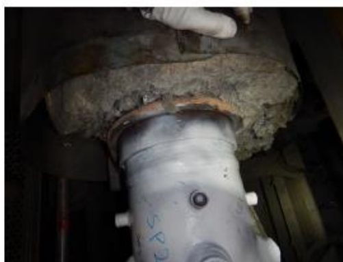
Rys. 14 Wskazanie na spoinach łączących podkładkę pod obejmą z rurociągiem. Schładzacz SP2 tył strona prawa.
