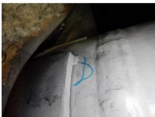
Rys. 13 Wskazanie na spoinach łączących podkładkę pod obejmą z rurociągiem. Schładzacz SP2 tył strona prawa.
