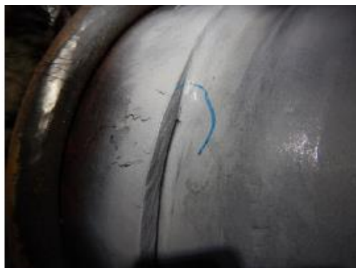
Rys. 12 Wskazanie na spoinach łączących podkładkę pod obejmą z rurociągiem. Schładzacz SP2 tył strona prawa.
