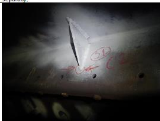
Rys. 14 Wskazania na złączu spawanym wspornika separacji.
