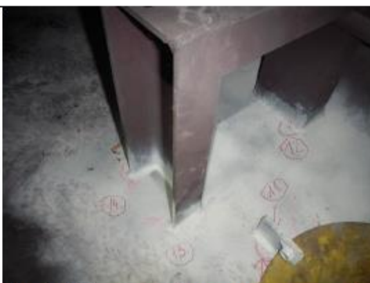
Rys. 6 Wskazania na złączu spawanym wspornika separacji,
