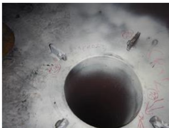
Rys. 10 Wskazania w rejonie rury opadowej nr 2
