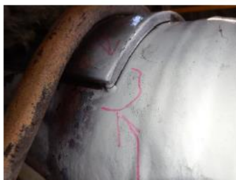
Rys. 8 Wskazanie na spoinach łączących podkładkę pod obejmą z rurociągiem. Schładzacz SP2 przód strona lewa
