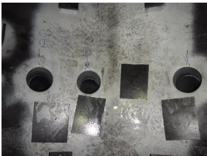
Rysunek 24 Wskazania na I, III, IV rurze opadowej licząc od tylnej ściany walczaka w drugim rzędzie carga 3
