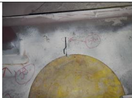
Rys. 19 Wskazania na złączy spawanym wspornika separacji.
