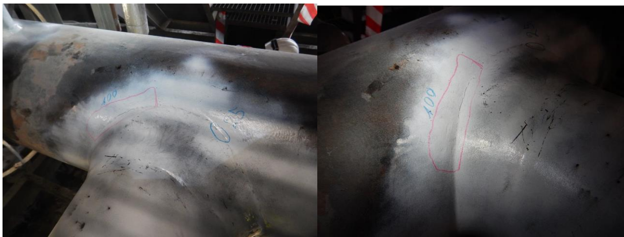
Rysunek 9 Dwa niedopuszczalne wskazania na złączu spawanym o długościach 100 i 25 mm.
