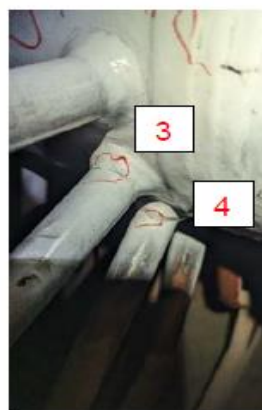
Rys. 5. Dwa wskazania na części lewej komory w miejscu podziału komory. Widok od przodu kotła.
