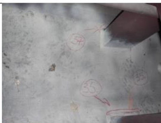
Rys. 18 Wskazania na złączy spawanym wspornika separacji.
