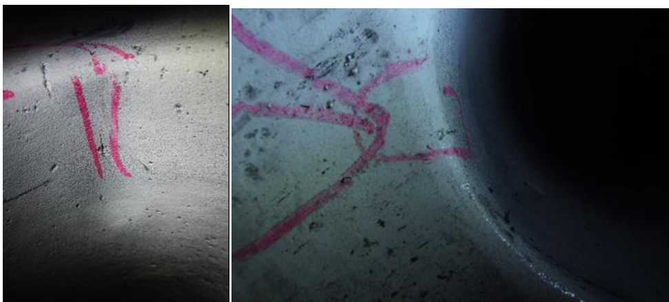
Rysunek 22 Wskazania na tworzącej oraz krawędzi rury opadowej. Zbliżenie z rys. nr 23
