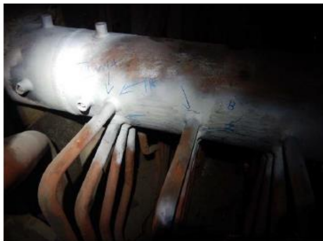
Rys. 7. Sześć wskazań na króćcach na części prawej komory po prawej stronie kotła, dwa pierwsze rzędy króćców od strony prawej. Widok od tyłu kotła.
