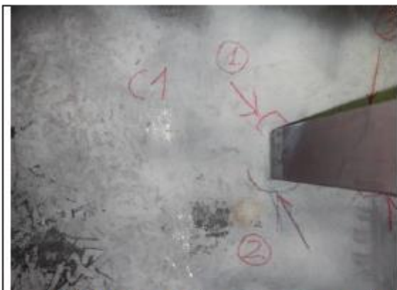
Rys. 3 Wskazania na złączu spawanym wspornika separacji,
