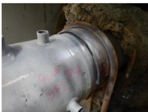
Rys. 7 Wskazanie na spoinach łączących podkładkę pod obejmą z rurociągiem. Schładzacz SP2 przód strona lewa
