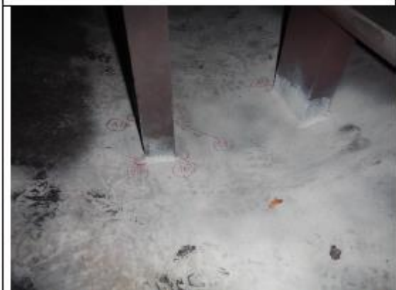
Rys. 7 Wskazania na złączu spawanym wspornika separacji,
