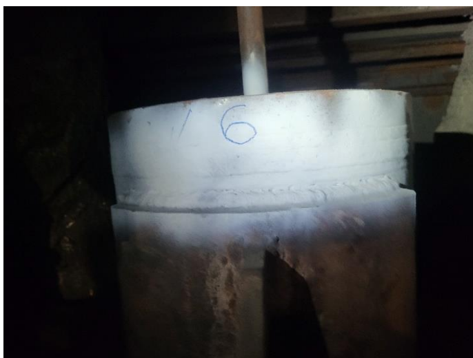
Rysunek 13 Obwodowe złącze spawane komory rur opadowych nr 6.
