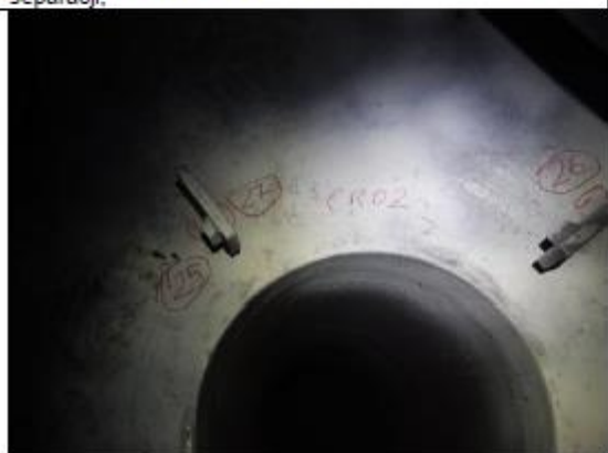
Rys. 11 Wskazania w rejonie rury opadowej nr 2
