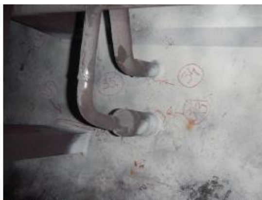
Rys. 16 Wskazania na złączach spawanych króćców wewnątrz walczaka.
