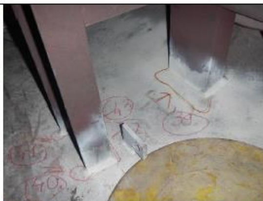
Rys. 20 Wskazania na złączy spawanym wspornika separacji.
