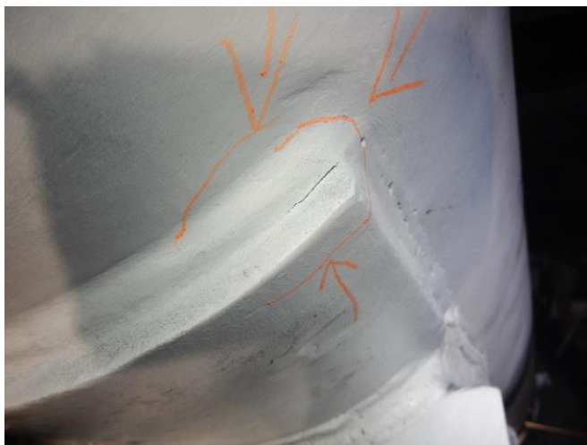
Rysunek 10 Wskazanie na złączu spawanym łączącym komorę z podporą.
