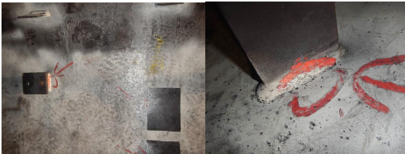
Rysunek 19 Wskazanie na złączy spawanym wspornika separacji za pierwszym rzędem rur opadowych w dolnej części walczaka, carga 4
