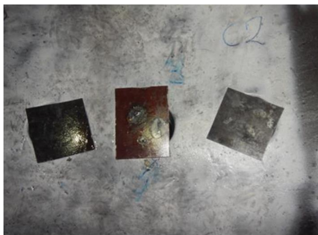
Rysunek 17 Wskazania na II rurze licząc od tylnej ściany walczaka w trzecim rzędzie od lewej strony, carga 2.
