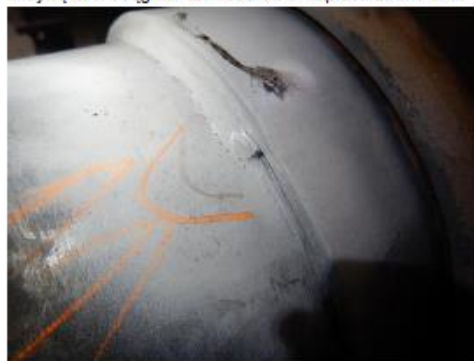
Rys. 10 Wskazanie na spoinach łączących podkładkę pod obejmą z rurociągiem. Schładzacz SP2 tył strona lewa.
