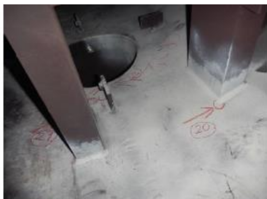
Rys. 9 Wskazania na złączu spawanym wspornika separacji.
