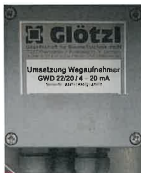
Zdj. 3. Przetworniki do czujników przemieszczeń GWD 22/20.
