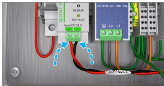
Rysunek 10: Obwód zasilania rezerwowego (Backup) (24 VDC).
