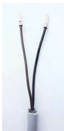
Przewody sensora napięciowego (Czarny / Brązowy)
