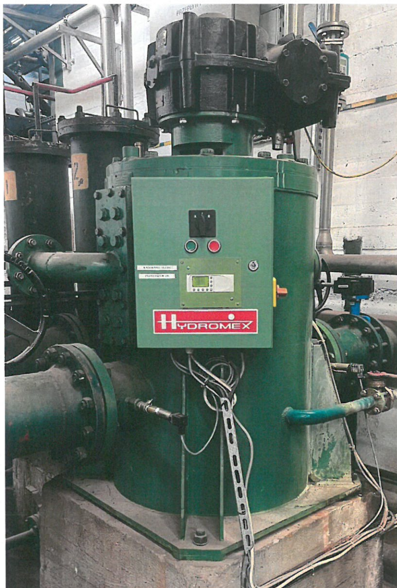
Zdjęcie 1. Filtr obrotowy samoczyszczący FOS 250.
