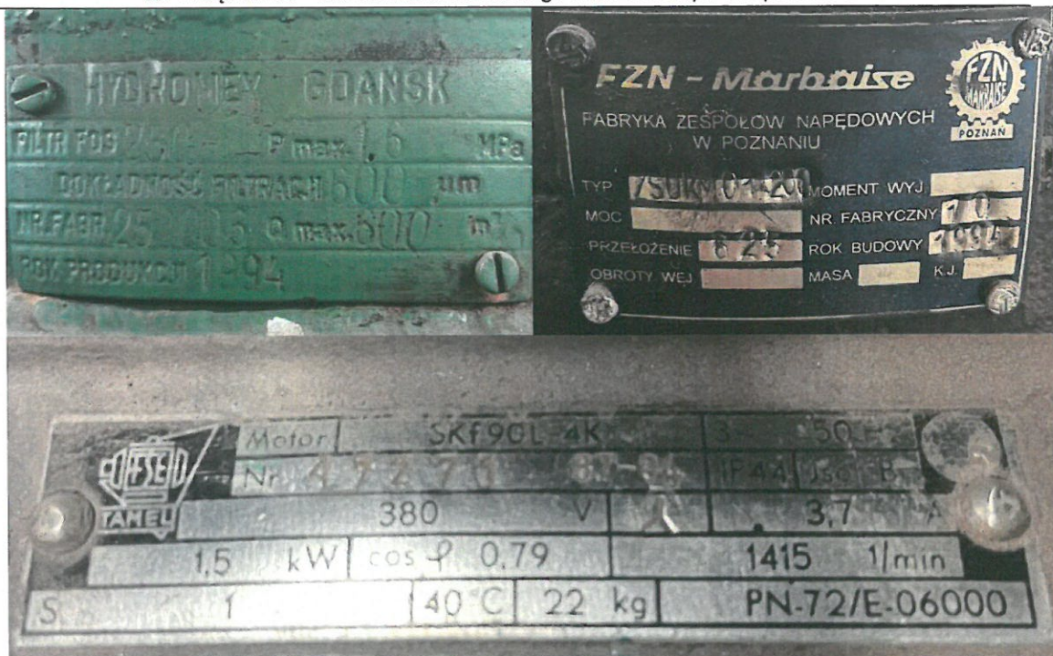
Zdjęcie 2. Tabliczki znamionowe filtra obrotowego.
