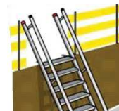
Rys. 9. Przedstawia sposób bezpiecznego wejścia i wyjścia z wykopu
