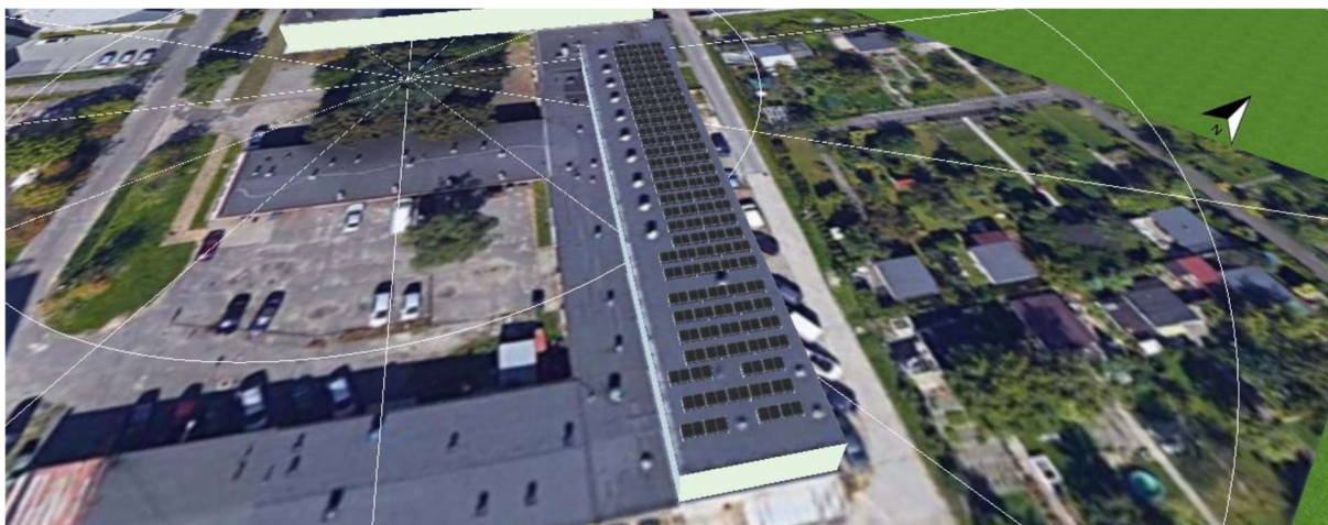
Fotografia 1. Proponowane rozmieszczenie modułów PV na dachu budynku
