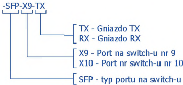
Sposób oznaczania Patchcordów światłowodowych:
