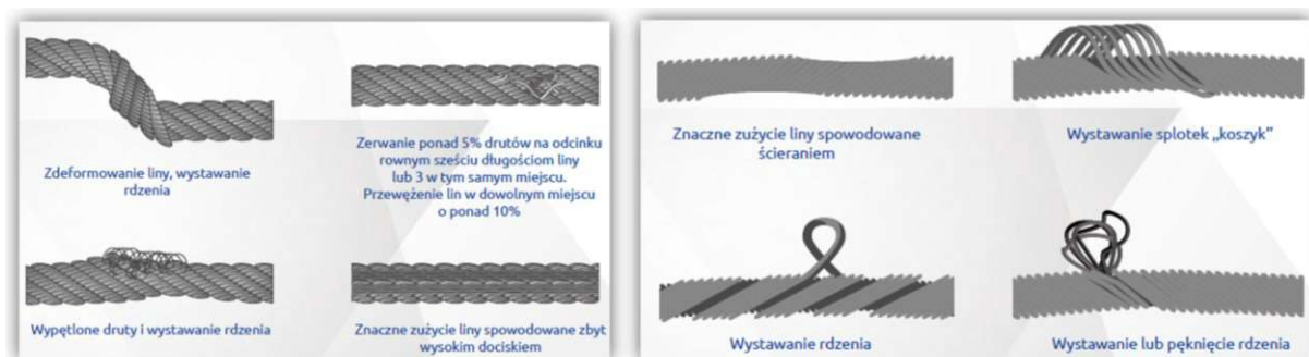
Rysunek 21 Zawiesia linowe – znamiona uszkodzeń
