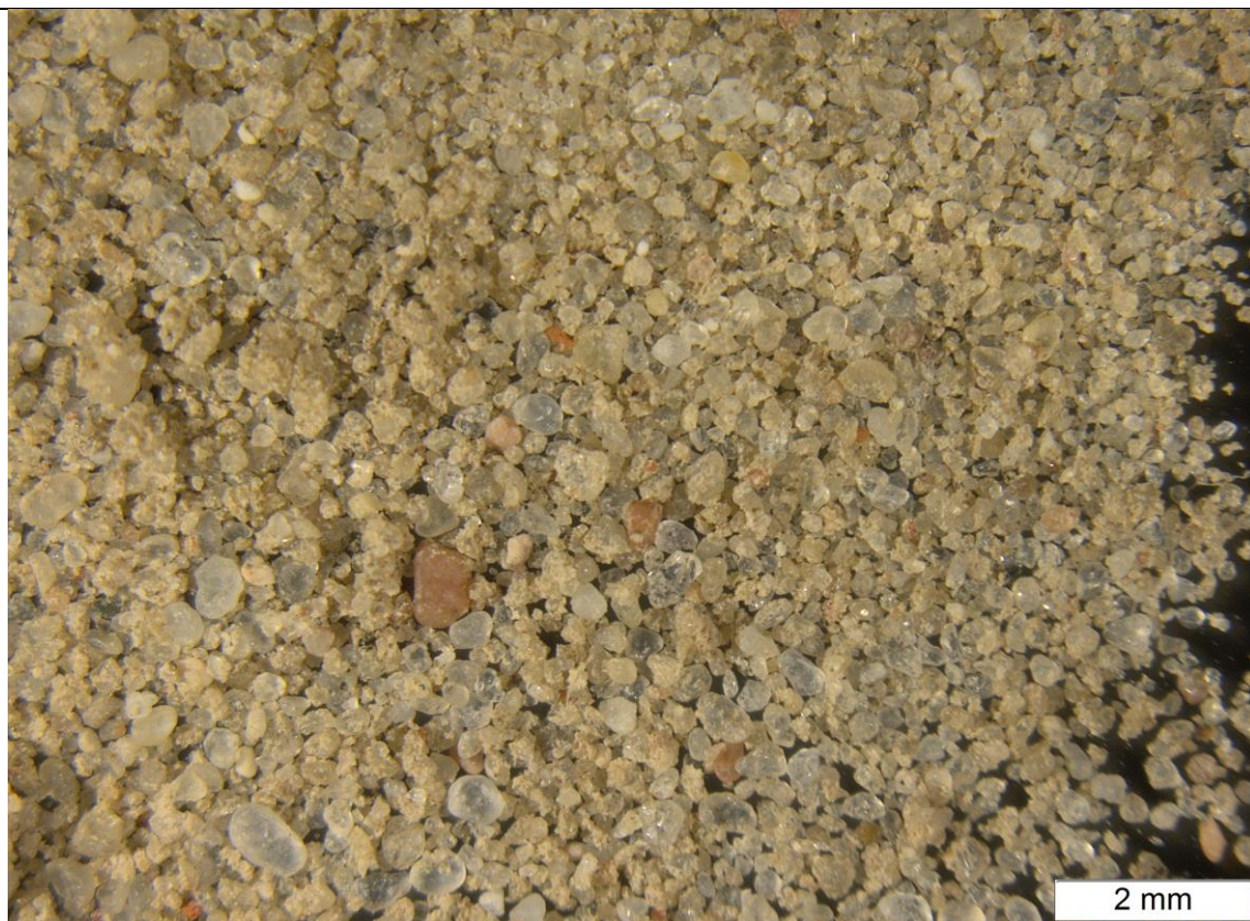
Fotografie mikroskopowe pozostałości próbki nr 1 nieroztworzonej w kwasie
