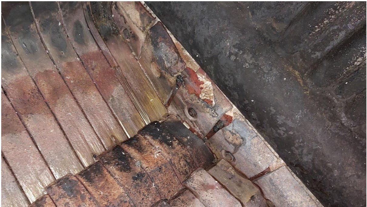
Zdj. 1 Ruszt oraz płyty ochronne boczne w rejonie sklepienia zapłonowego
