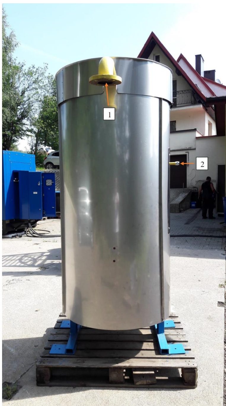
Rys. 3. Obudowany osuszacz gazu ziemnego – zbiornik adsorpcyjny.
