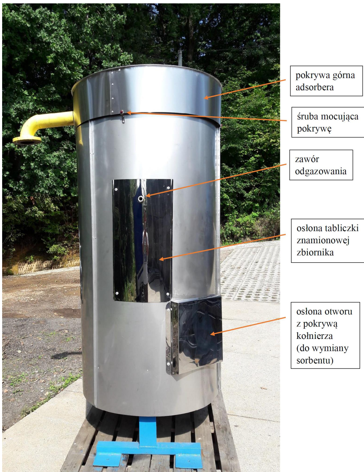
Rys. 4. Obudowany osuszacz gazu ziemnego.
