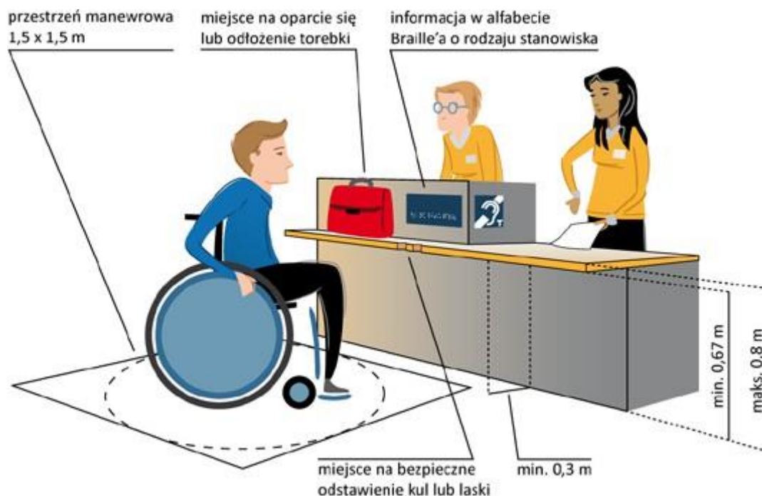
Ilustracja 35. Przykład dostępnej lady umożliwiającej podjechanie wózkiem, odłożenie kul, laski lub bagażu oraz wyposażonej w pętlę indukcyjną, rys. Maria Görlich-Opyd
