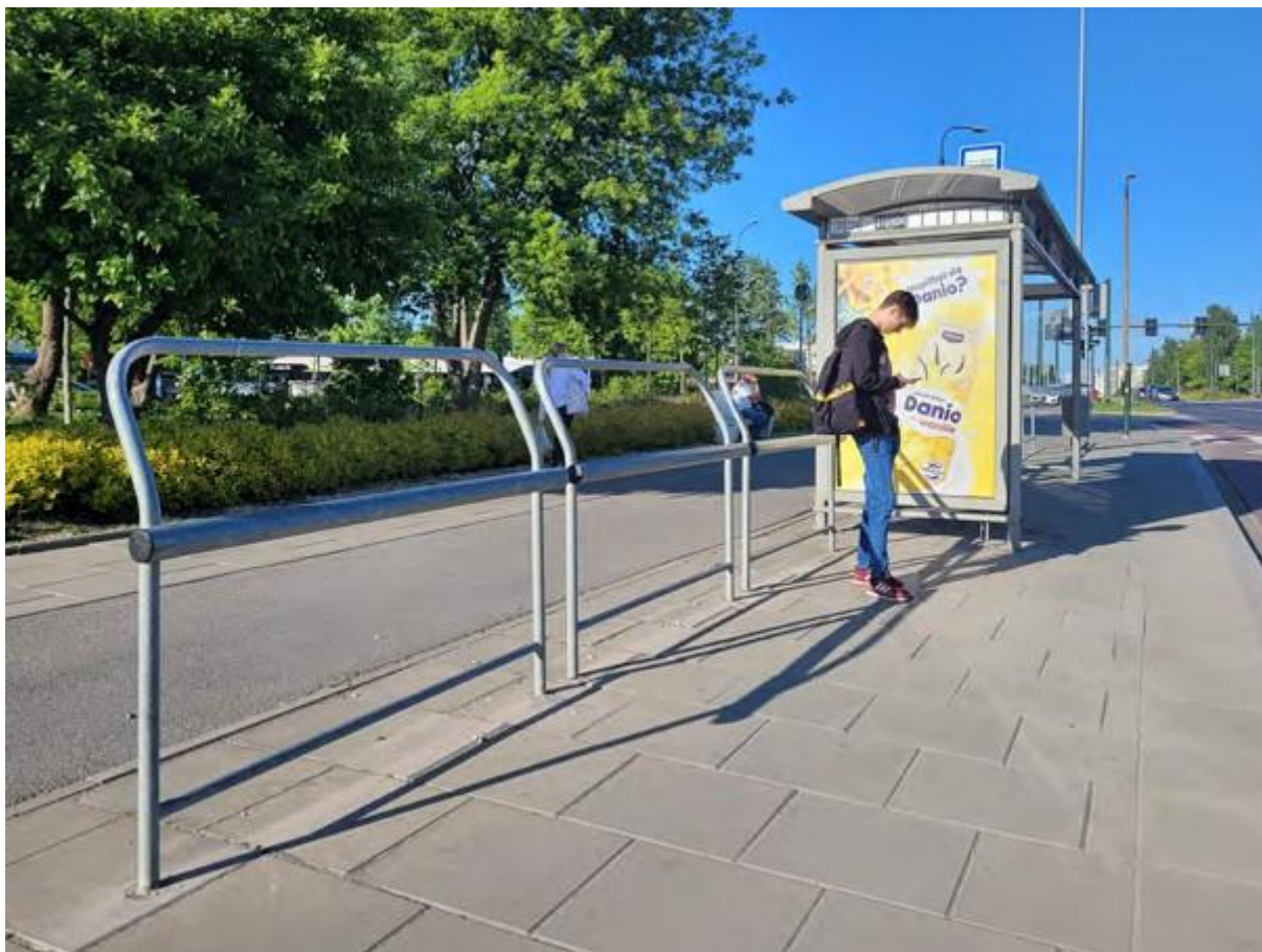
Ilustracja 28. Przykład barierki zapewniającej możliwość odpoczynku w pozycji półsiedzącej, wyposażonej w poziomy element ułatwiający wykrycie przeszkody za pomocą białej laski, fot. Katarzyna Guratowska
