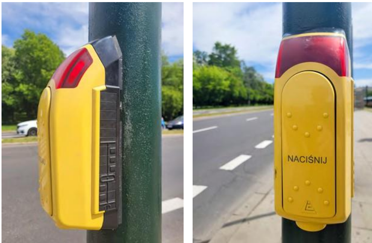
Ilustracja 27. Przykład zastosowania schematu skrzyżowania (po lewej), umieszczonego obok przycisku wzbudzającego sygnalizację światła zielonego (po prawej), fot. Katarzyna Guratowska
