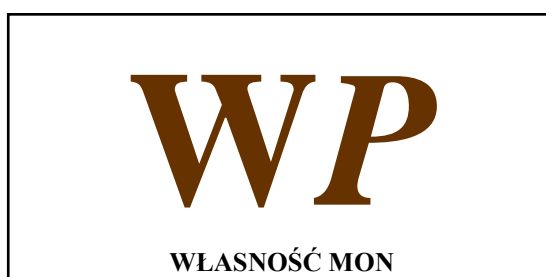
Rysunek 17 - Wzór tabliczki opisowej studni kablowej
