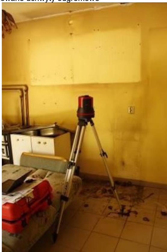
Fot.34- lokal nr 4 – stanowisko pomiarowe deformacji płaszczyzn; na statywie tachimetr laserowy
