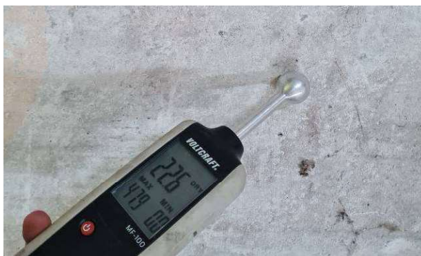
Fot. Szacunkowe badanie poziomu zawilgocenia ścian.
