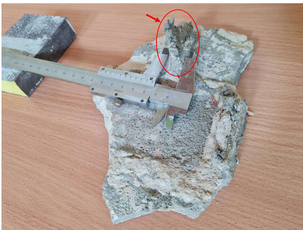
Fot. Usunięty fragment tynku, Budynek Szkolny, część pierwotna, ściana północna-wschodnia Auli. (oznaczony fragment tynku wchodzącego w głąb pęknięcia, świadczący o braku właściwych, przeszłych napraw pęknięcia)
