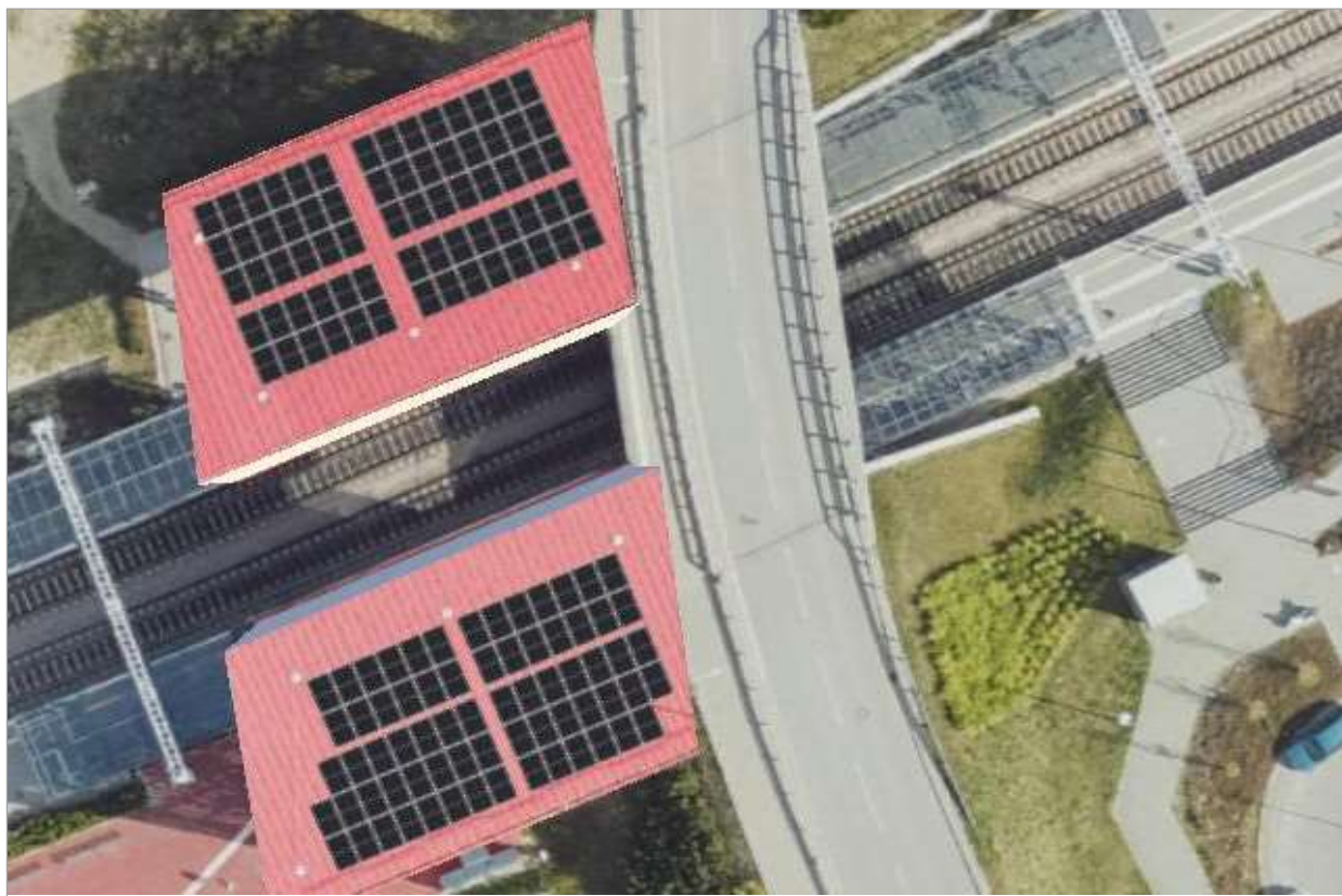
Rys. 3 Propozycja rozmieszczenia panel PV na przystanku Gdańsk Jasień
