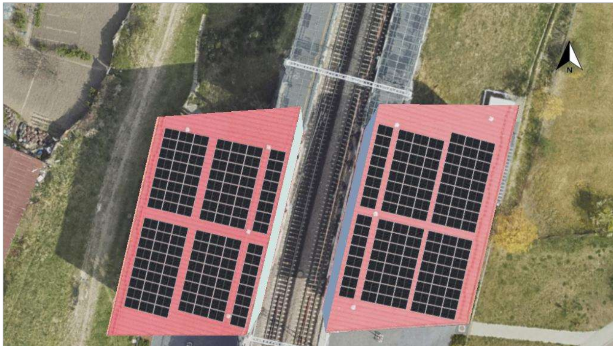
Rys. 2 Propozycja rozmieszczenia panel PV na przystanku Gdańsk Niedźwiednik
