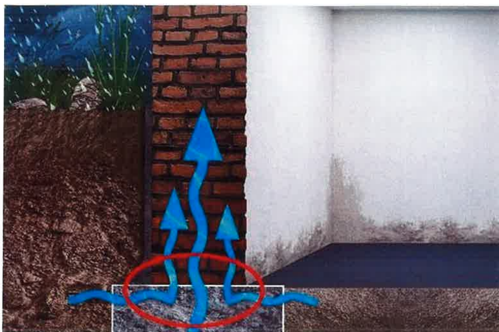
Konstrukcja murowana z przeponą Zablokowano wodę kapilarną
