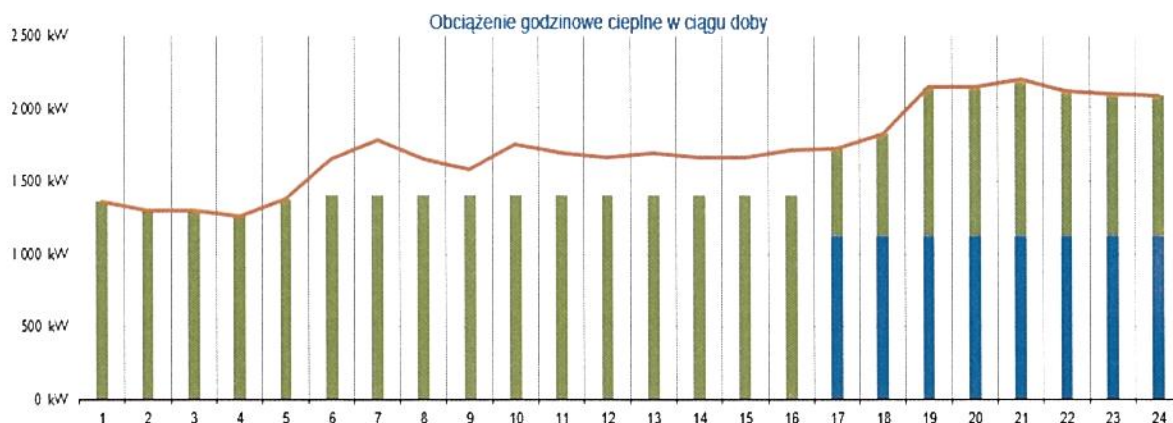
Rys. 9 Ciepło oddane do sieci oraz praca CHP i kotła gazowego w dniu 18 września
