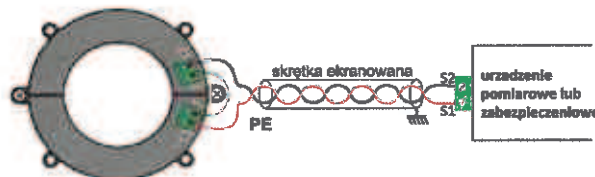
Schemat przyłączeniowy przetwornika CRR
