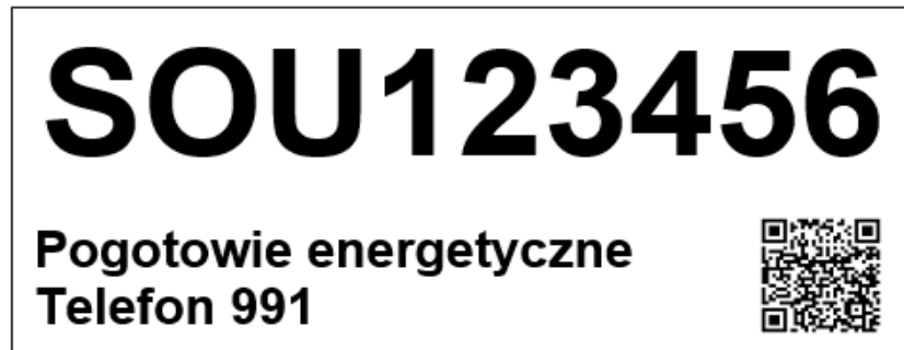
5.3.10. Etykieta kablowa wykorzystywana przy opisywaniu kabli nN
