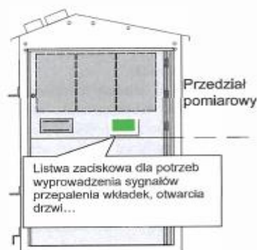
Rozdzielnica nN napowietrzna
