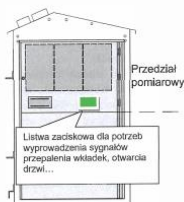
Rozdzielnica nN napowietrzna
