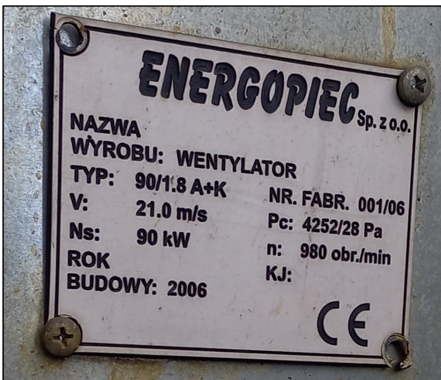
Fot. 1. Wentylator ciągu typ 90/1.8 A+K – tabliczka znamionowa.
