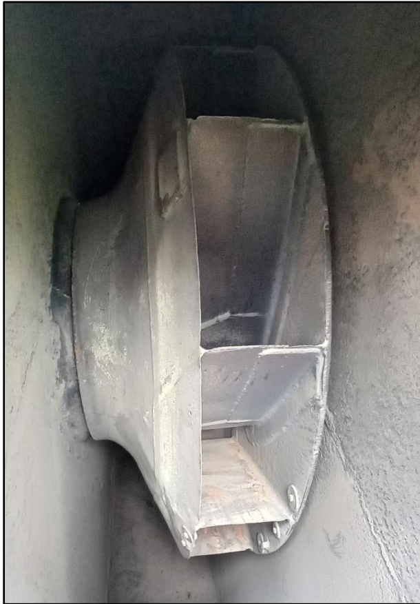
Fot. 2. Wirnik wentylatora typ 90/1.8 A+K
