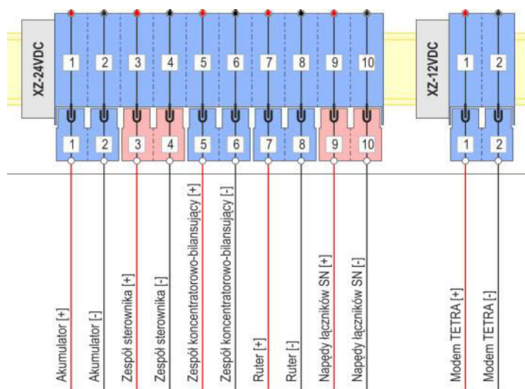
Rys. 2.1. Listwy wyprowadzenia zasilania 24 VDC i 12 VDC z zasilacza
