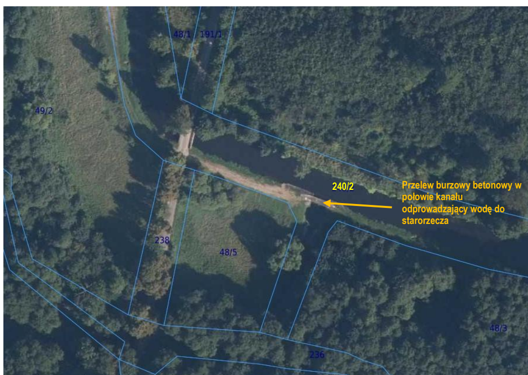
Rys. 3 Przelew burzowy w połowie kanału derywacyjnego
