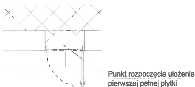
Schemat ułożenia pierwszej płytki podłogowej
