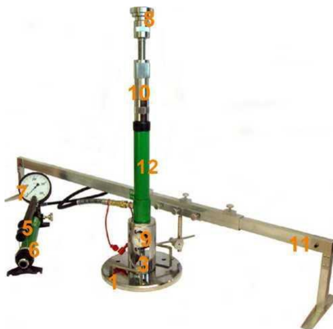
Rys. 1.2 Aparatura VSS z jednopunktowym pomiarem przemieszczenia płyty
