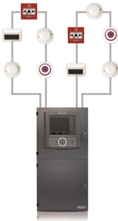
Rys. 2.2/1 Przykładowa konfiguracja sytemu POLON 6000 w architekturze nierozproszonej (tradycyjnej)
