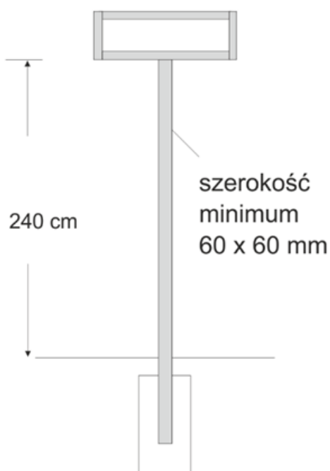
Rys. 95 Przykłady konstrukcji tablic
