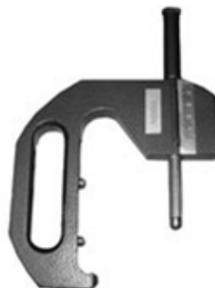
Rys. 10. Przyrząd do pomiaru grubości obręczy
