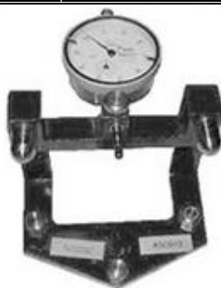
Rys. 11. Przyrząd do pomiaru płaskich miejsc
