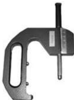
Rys. 11. Przyrząd do pomiaru grubości obręczy
