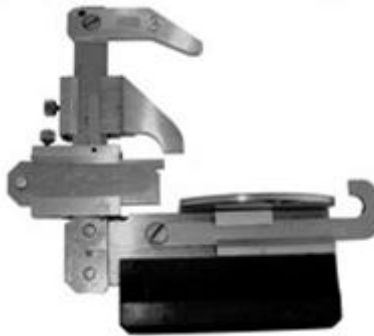
Rys. 9. Suwmiarka do pomiaru zarysu obręczy
