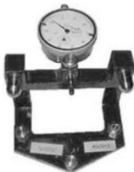
Rys. 12. Przyrząd do pomiaru płaskich miejsc
