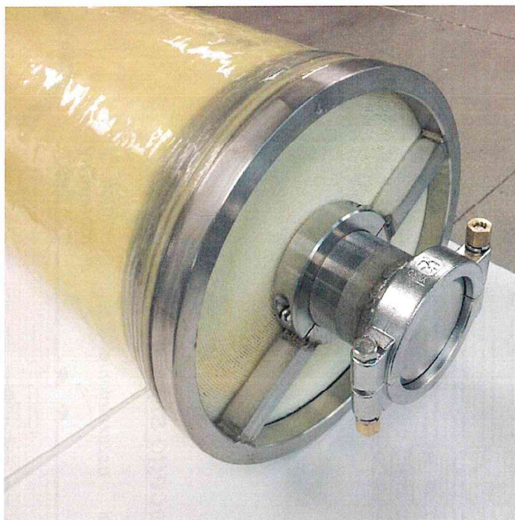
Zdjęcie nr 1. Wkład membranowy wraz z zaciskiem łączeniowym.
