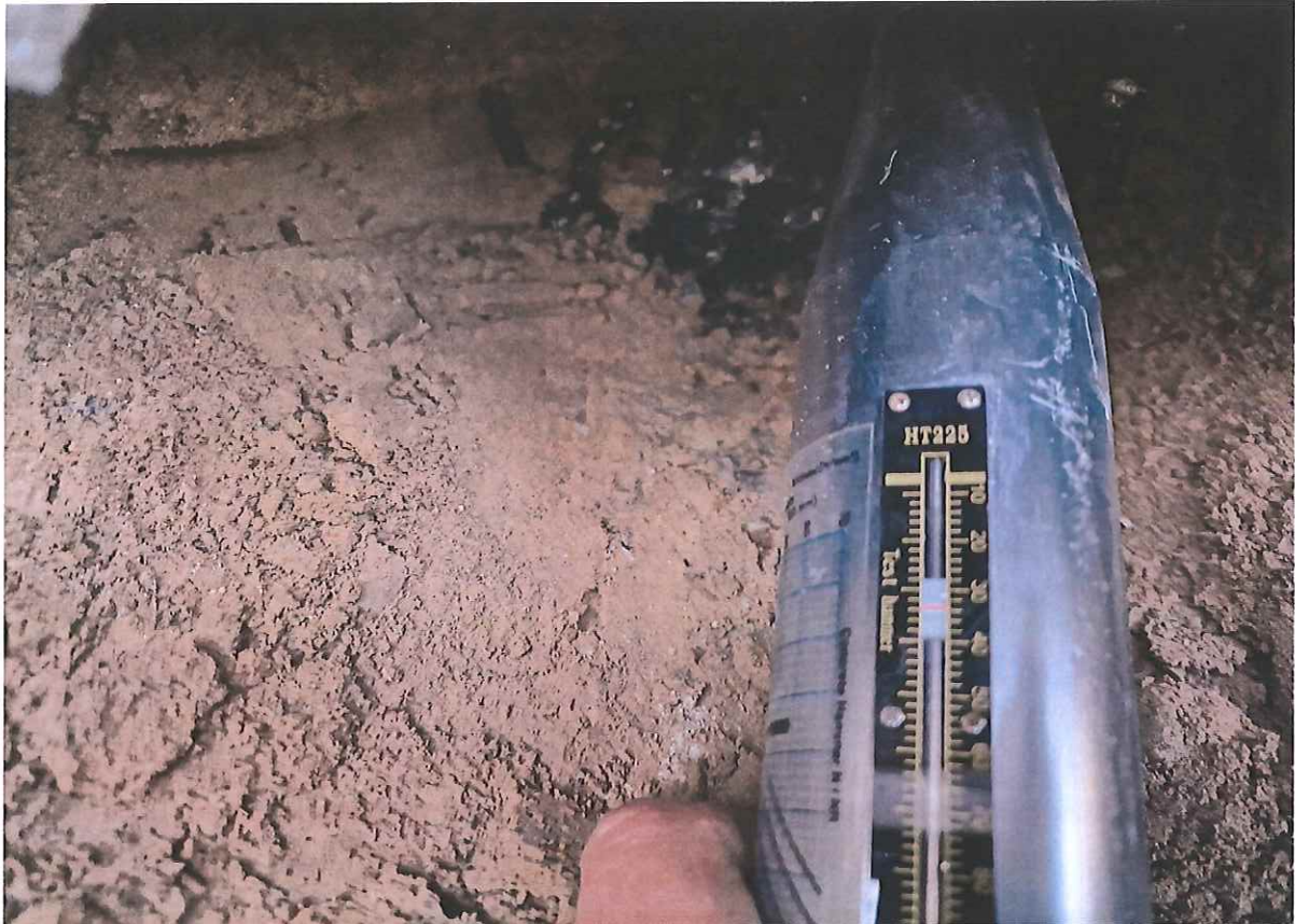
Fot. 8. Badanie Młotkiem Schmidta.
