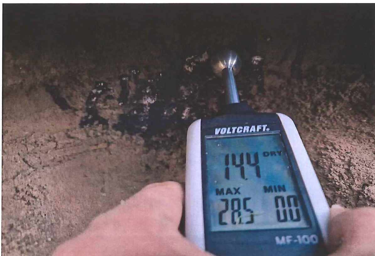
Fot. 9. Badanie wilgotności betonu.
