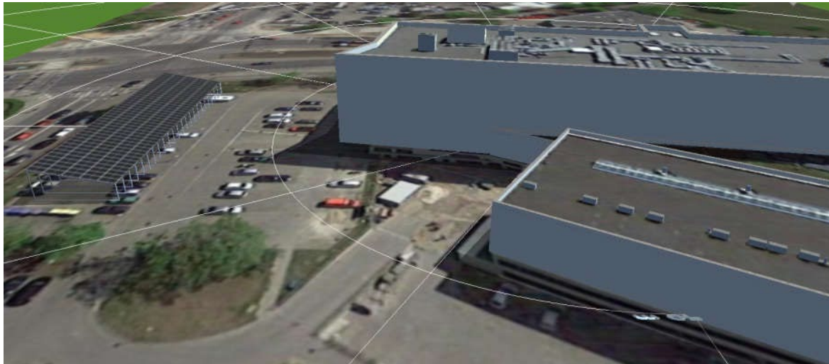
Rysunek nr. 21. Przykładowa wizualizacja car-portowej instalacji fotowoltaicznej nr 3 (widok z perspektywy).
