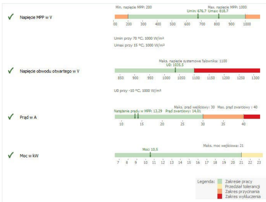
Rysunek nr 26. Rozkład parametrów napięciowo-prądowych dla MPP-6. (wyniki symulacji projektowej w PVSol Premium: źródło własne).
