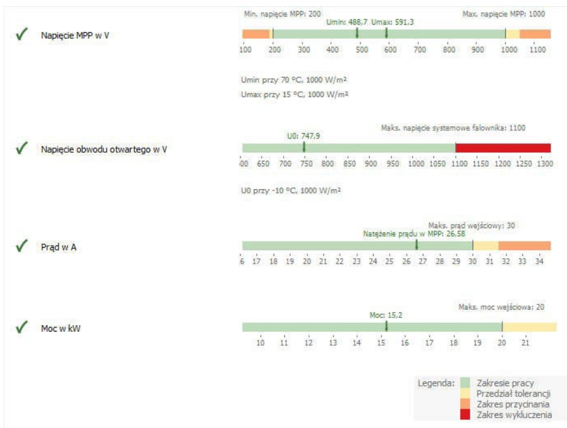
Rysunek nr 16. Rozkład parametrów napięciowo-prądowych dla MPP-1 oraz MPP-2. (wyniki symulacji projektowej w PVSol Premium: źródło własne).
