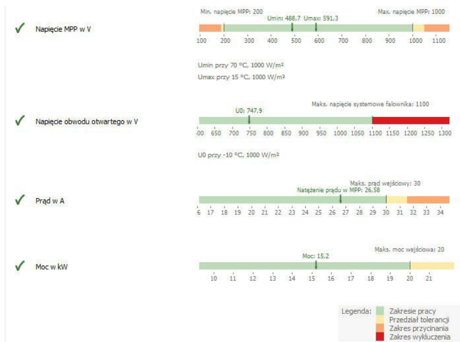
Rysunek nr 8. Rozkład parametrów napięciowo-prądowych dla MPP-1 oraz MPP-2. (wyniki symulacji projektowej w PVSol Premium: źródło własne).
