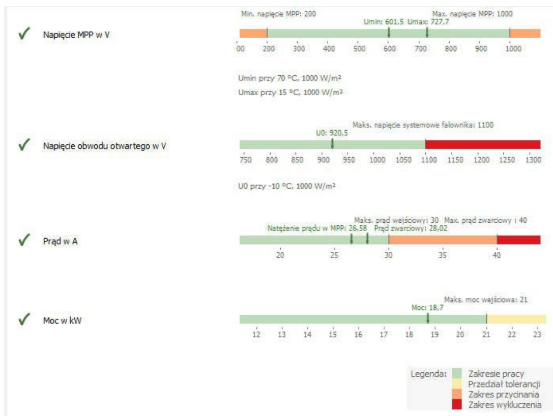
Rysunek nr 25. Rozkład parametrów napięciowo-prądowych dla MPP-3 oraz MPP-4. (wyniki symulacji projektowej w PVSol Premium: źródło własne).
