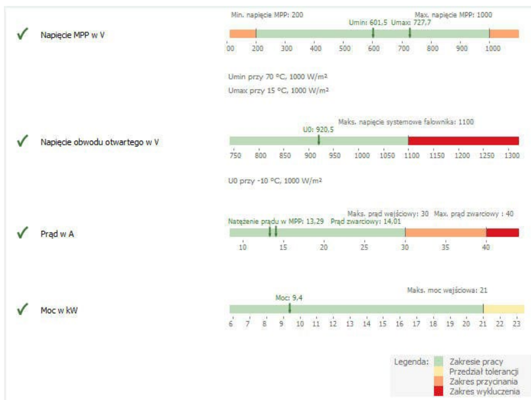
Rysunek nr 27. Rozkład parametrów napięciowo-prądowych dla MPP-7. (wyniki symulacji projektowej w PVSol Premium: źródło własne).
