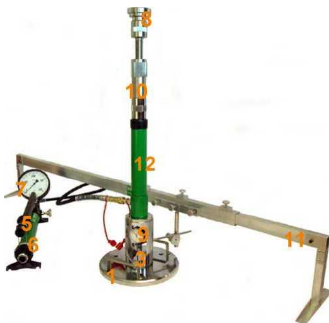
Rys. 1.2 Aparatura VSS z jednopunktowym pomiarem przemieszczenia płyty
