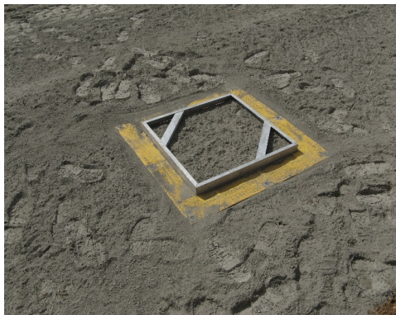
Tacka pomiarowa ze spoiwem rozłożonym na powierzchni 0,5 m 2
