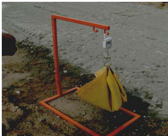
Ważenie tacki pomiarowej ze spoiwem
