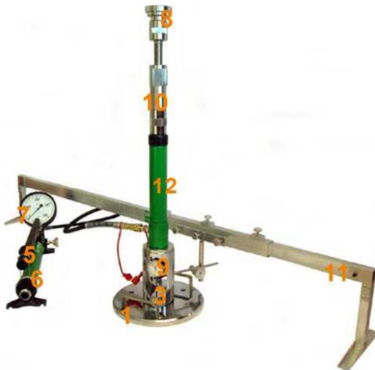
Rys. 1.2 Aparatura VSS z jednopunktowym pomiarem przemieszczenia płyty
