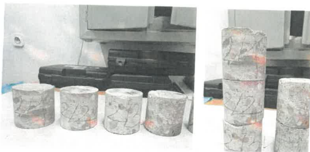
Rys. 3. Próbkki betonowe przygotowane do badania niszczącego na prasie (próbki 2/1; 2/2; 2/3 pochodzą z dźwigara głównego, próbki 1/1; 1/2 pochodzą z przyczółka).
