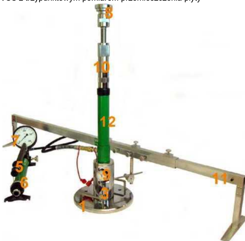
Rys. 1.2 Aparatura VSS z jednopunktowym pomiarem przemieszczenia płyty
