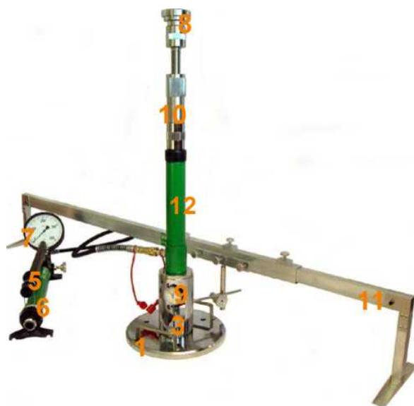
Rys. 1.2 Aparatura VSS z jednopunktowym pomiarem przemieszczenia płyty
