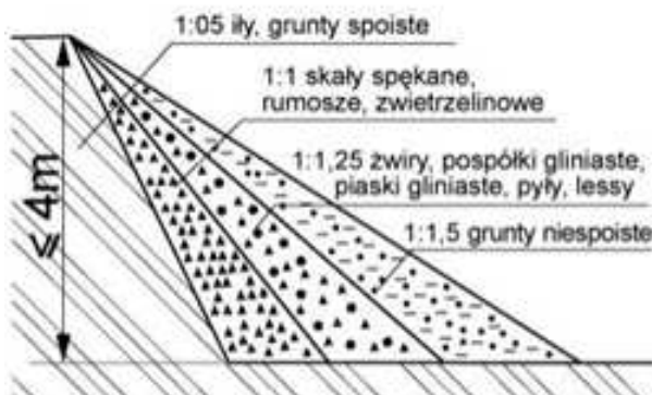
Rys. 2 Bezpieczne pochylenia skarp
