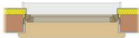
Rys. 21. Schemat montażu okna w ścianie z ociepleniem zewnętrznym
