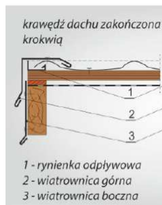
Rys. 12. Schemat zastosowania wiatrownicy
