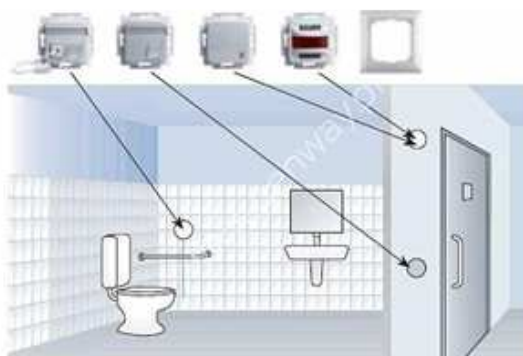
Rys. 3. Schemat instalacji przyzywowej
