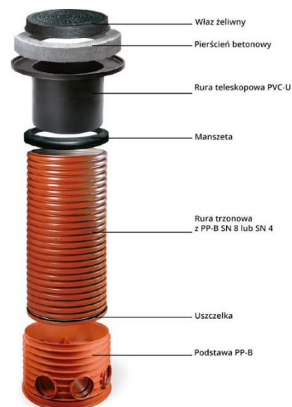
Rys. 5. Schemat studzienki kanalizacyjnej
