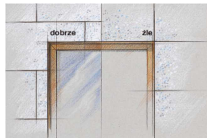
Rys. 26. Schemat układu płyt w pobliżu otworów
