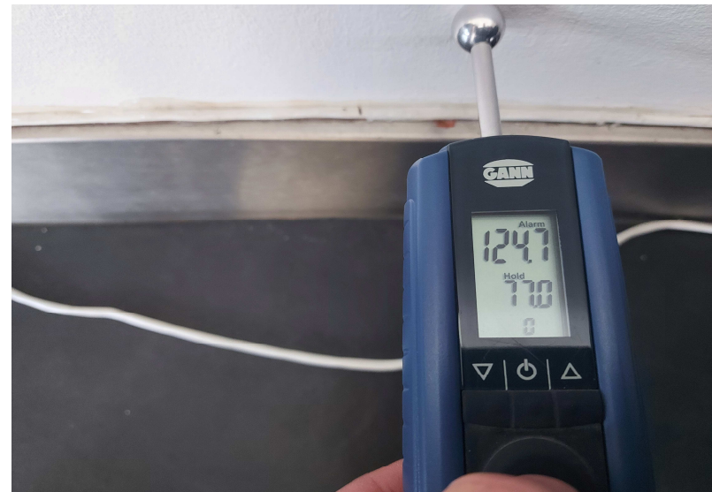
Fot.31 Pomiar wilgotnościowy ścian w poziomie piwnic – widoczne przekroczenie dopuszczalnej wilgotności
