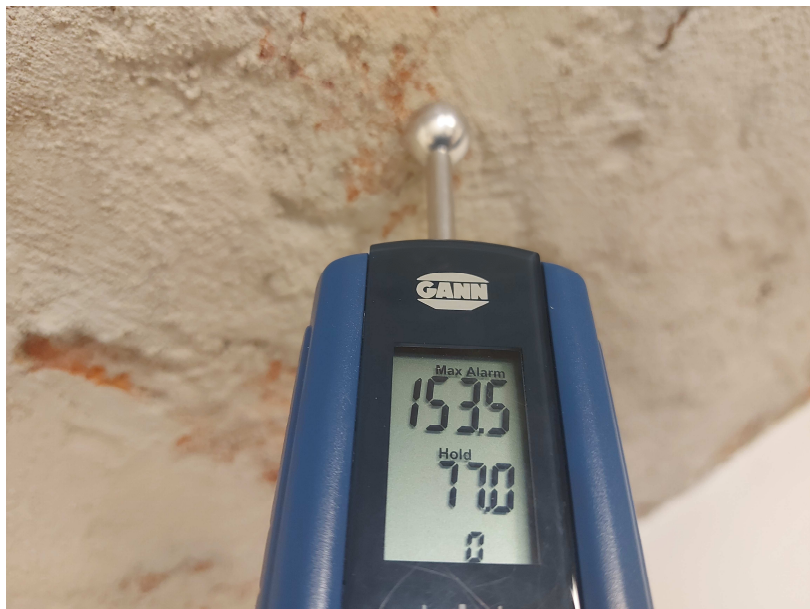
Fot.22 Pomiar wilgotnościowy ściany pom piwnicy – ściana zewnętrzna
