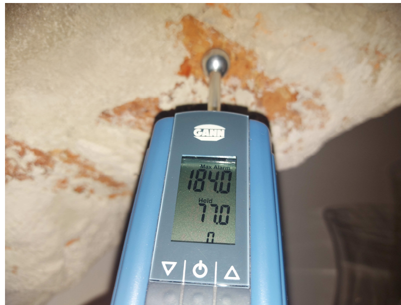
Fot.23 Pomiar wilgotnościowy stropu sklepieniowego pom piwnicy
