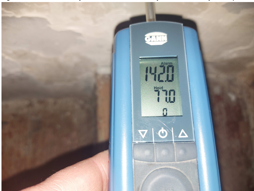
Fot.14 Pomiar wilgotnościowy ściany zewnętrznej klatki schodowej w poziomie parteru
