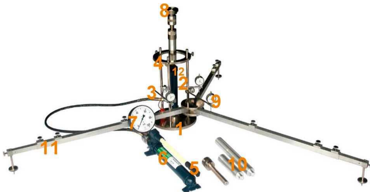
Rys. 1.1. Aparatura VSS z trzypunktowym pomiarem przemieszczenia płyty
