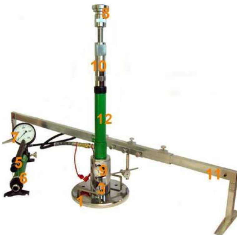
Rys. 1.2 Aparatura VSS z jednopunktowym pomiarem przemieszczenia płyty
