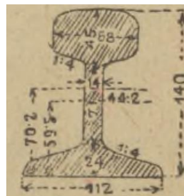
Geometria szyny ujawnionej w stropie
