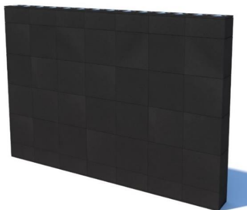
Rys. 5. Sposób wykonania ściany z pustaków poliuretanowo-gumowych.
