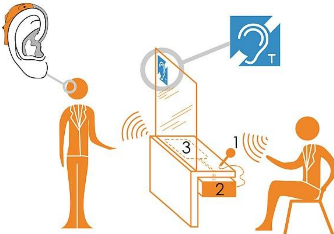
Schemat działania pętli stanowiskowej, zamontowanej na stałe pod blatem.
