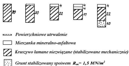
Rys. 4. Przykładowe wybrane konstrukcje nawierzchni utwardzonego pobocza z kruszywa łamanego niezwiązanego
