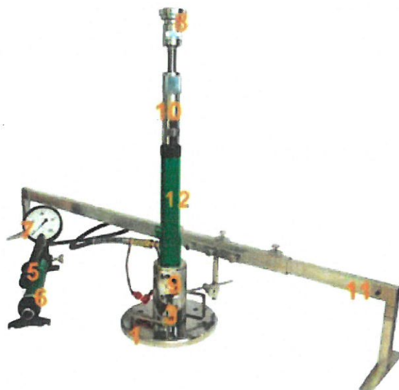
Rys. 1.2 Aparatura VSS z jednopunktowym pomiarem przemieszczenia płyty
